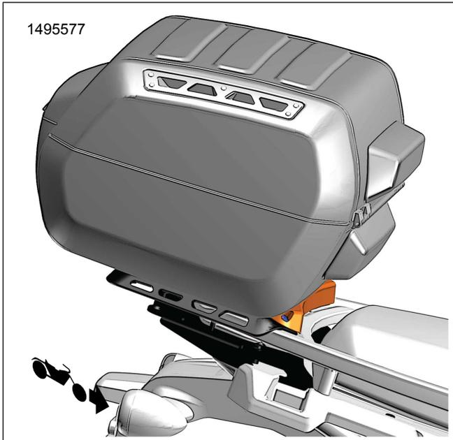
그림 14. 상단 케이스 설치
