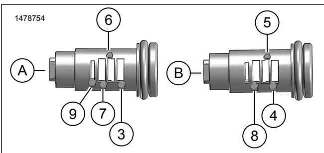
그림 4. 스프링 및 텀블러 설치 위치(일반적인 경우)
