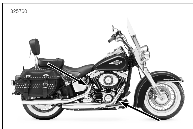
圖33. 氧氣感測器位置（排氣管的內側）
