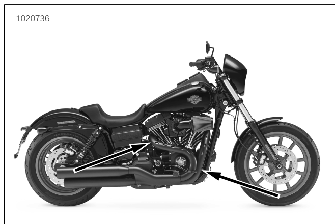
圖40。氧氣感測器位置（排氣管的內側）
