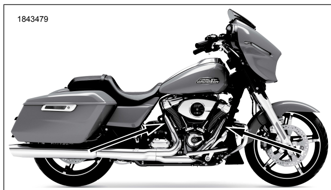
圖2。氧氣感測器位置(排氣管的內側)
