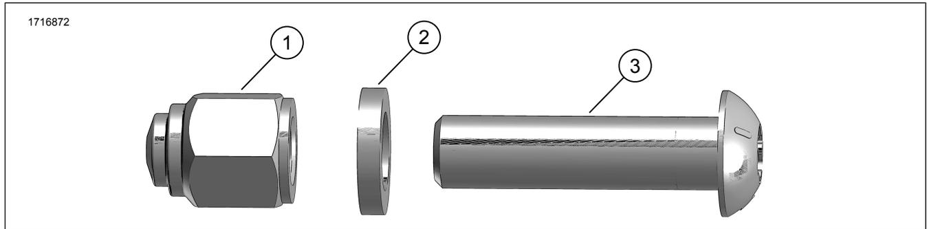
圖1。套件內容：腳樁螺絲工具包
