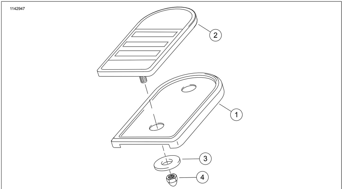
Figura 1. Conteúdo do kit: Kit de pastilha do pedal do freio cromado - componentes grandes
