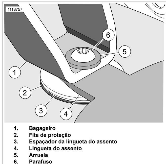
Figura 3. Instalação das ferragens
