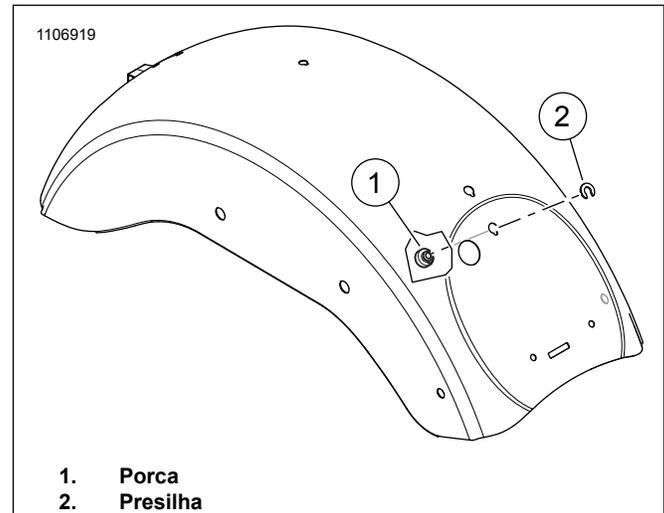
Figura 1. Porca do assento no para-lama (típica)
