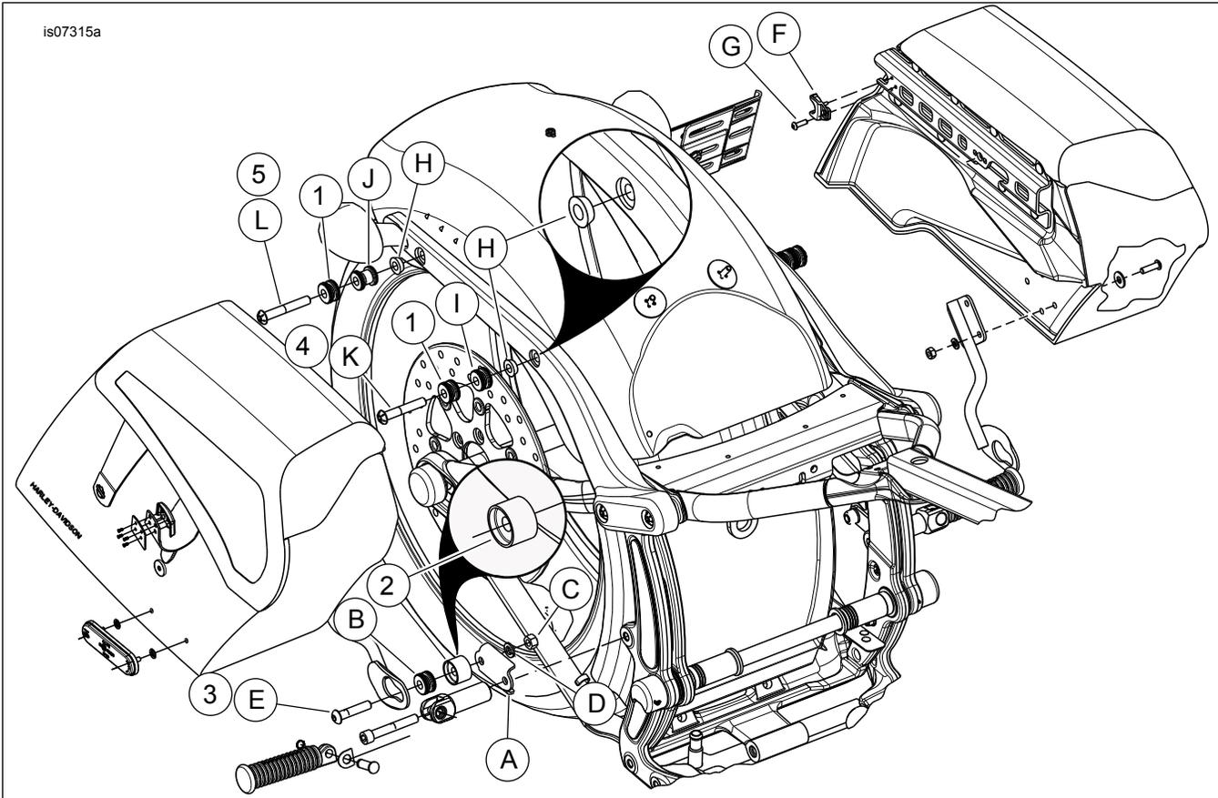
Figura 1. Peças de reposição: Kit do ponto de suporte do alforje removível (peça número 52300243)
