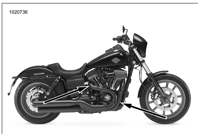
Figura 40. Localizações do sensor de oxigênio (lado interno dos canos de escape)
