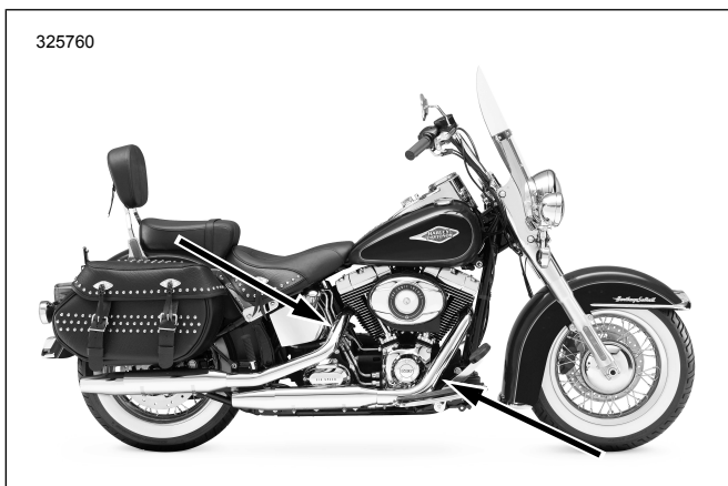
Figura 33. Localizações do sensor de oxigênio (lado interno dos canos de escape)
