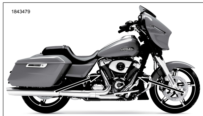
Figura 2. Localizações do sensor de oxigênio (lado interno dos canos de escape)
