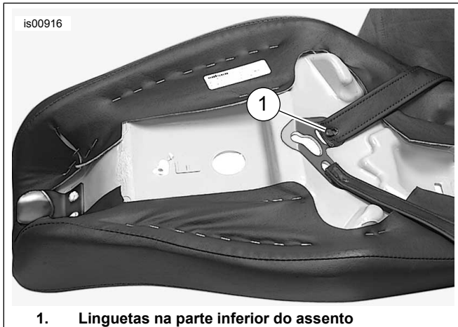
Figura 4. Lado de baixo do assento mostrando a tira de apoio instalada
