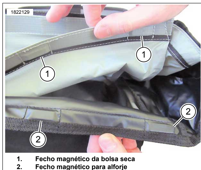
Figura 12. Instalação da bolsa seca
