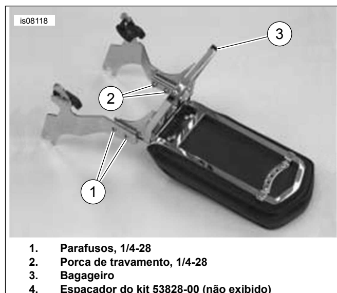
Figura 1. Bagageiro (exibido com as placas laterais removíveis)
