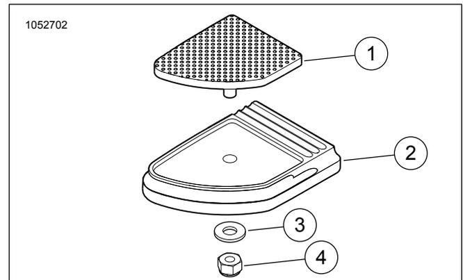
Figura 1. Peças de reposição: Kit de pastilha do pedal do freio pequeno
