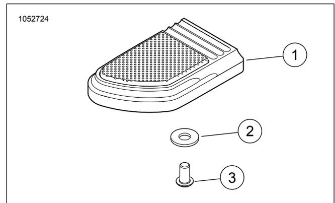
Figura 2. Peças de reposição: Kit de pastilha do pedal do freio grande
