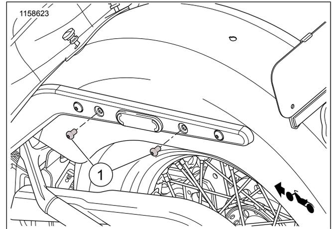
Figura 1. Remoção do parafuso – Para-lama traseiro
