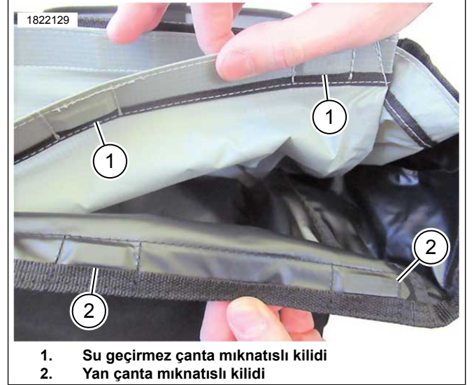
Şekil 12. Su Geçirmez Çantanın Takılması
