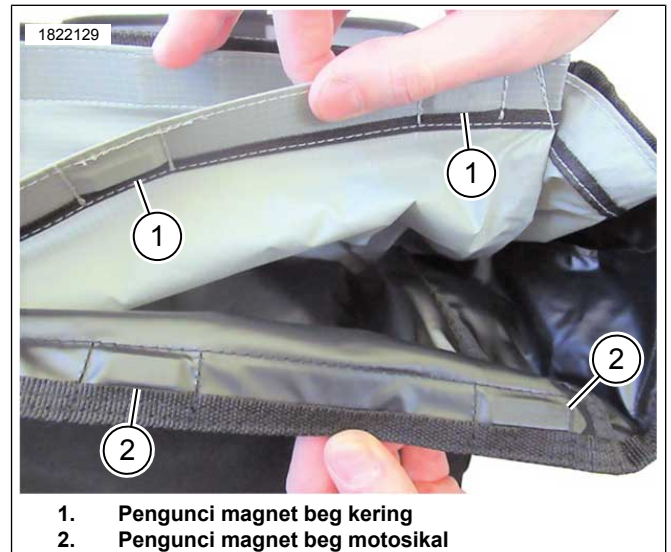
Rajah 12. Pemasangan Beg Kering
