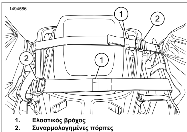
Εικόνα 3. Ιμάντες εγκάρσιοι στο μαξιλάρι
