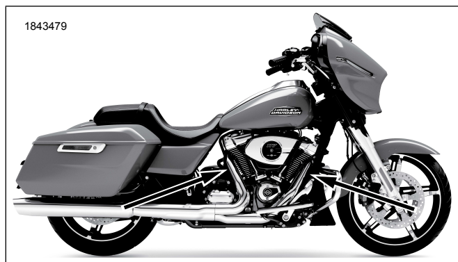
Ábra 2. A lambdaszondák elhelyezkedése (a kipufogócső belső felén)
