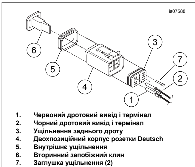
Малюнок 2. Вставте термінали у корпус розетки Deutsch
