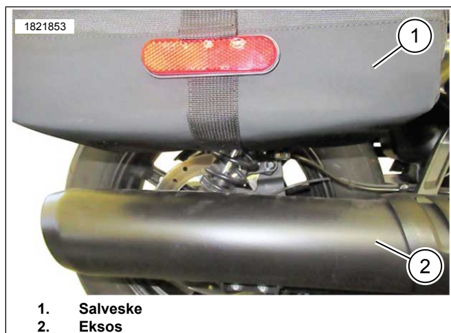
Figur 11. Klaring til eksosanlegg
