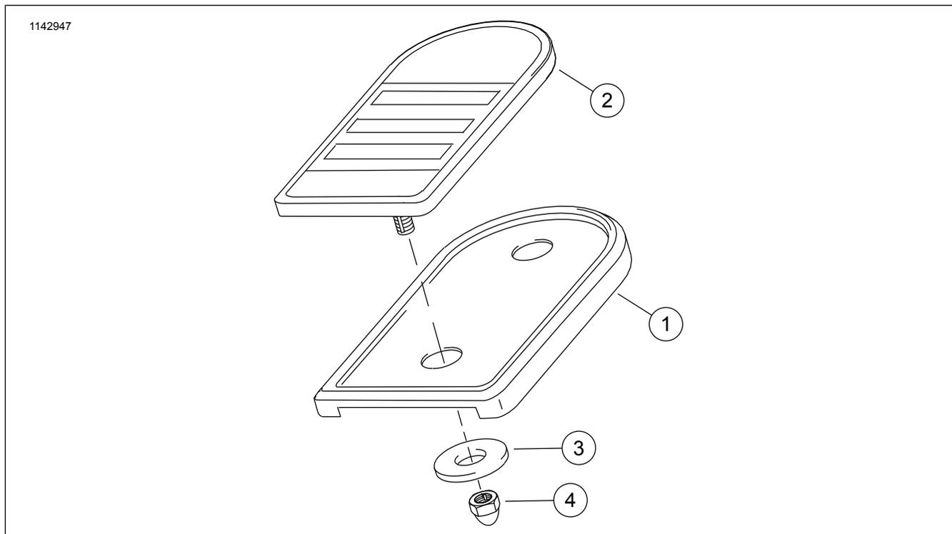
Рисунок 1. Содержимое комплекта Компоненты комплекта большой накладки педали тормоза, хром
