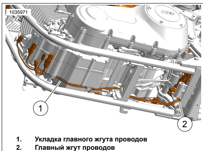
Рисунок 36. Укладка жгута проводов
