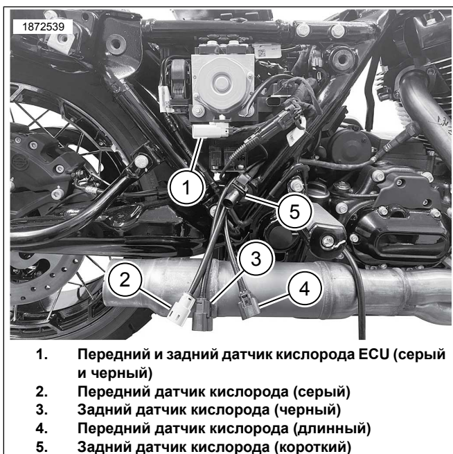
Рисунок 3. Укладка жгутов проводов с серым и черным разъемами
