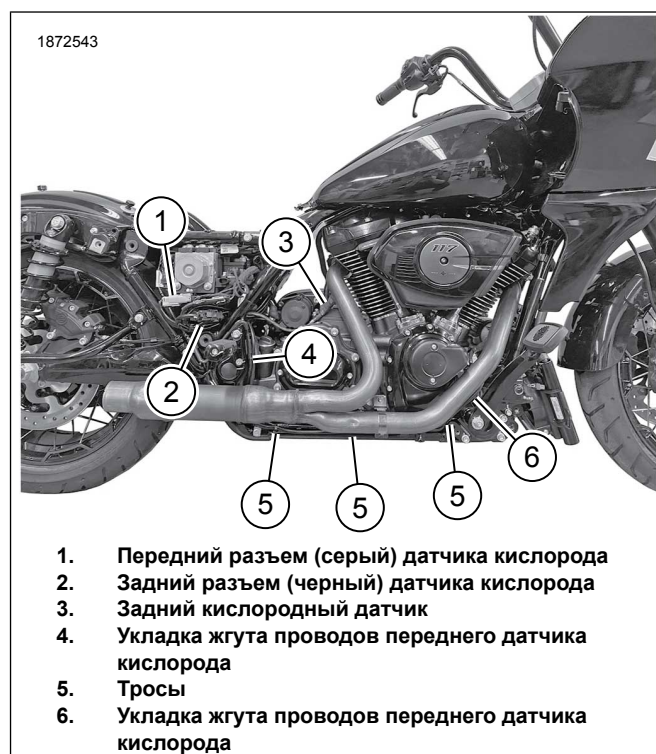
Рисунок 8. Укладка жгута проводов датчика АТМ
