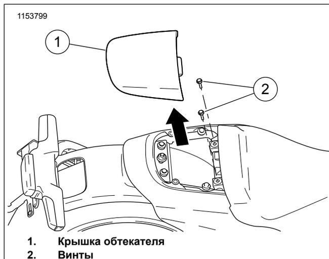
Рисунок 1. Снятие крышки обтекателя и винтов
