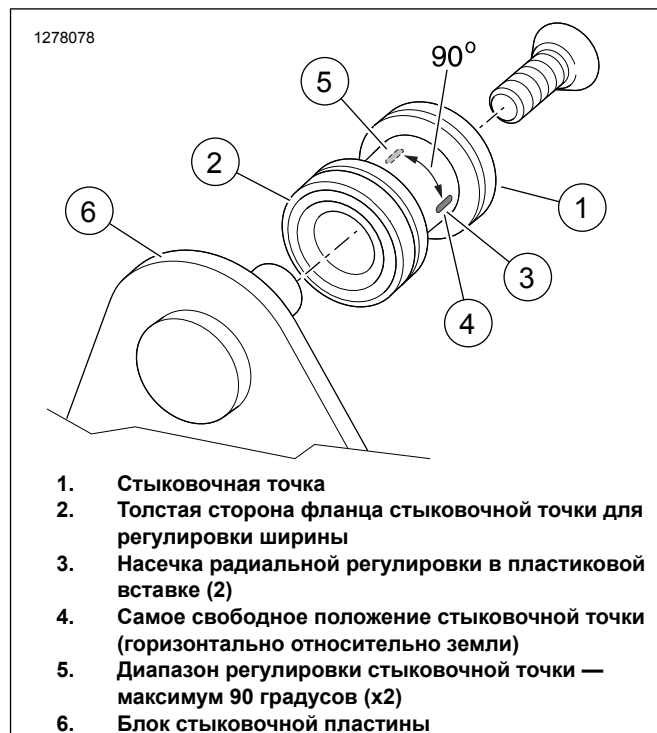
Рисунок 2. Установка стыковочной точки
