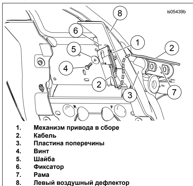
Рисунок 9. Установка механизма привода в сборе с воздушным дефлектором для центральной части рамы
