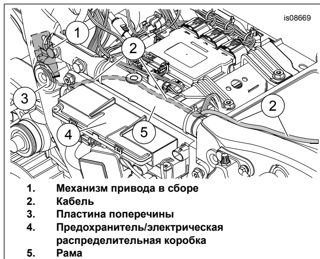
Рисунок 10. Прокладка кабеля
