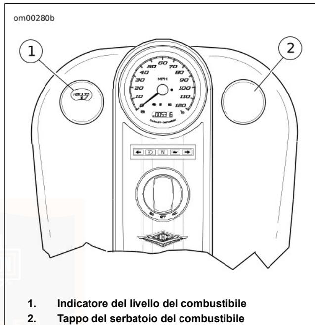
Figura 30. Serbatoio del combustibile: FLHR/FLHRC
