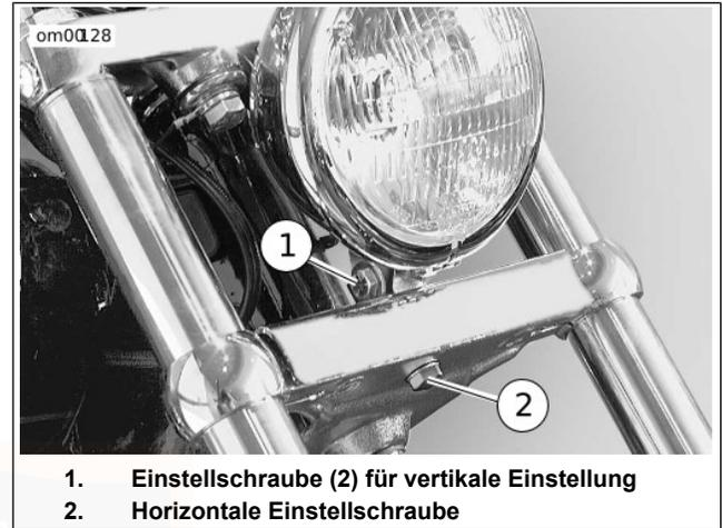
**Abbildung 68. Scheinwerfereinstellung: FLSTC, FLSTF, FXSTB, FXST**
