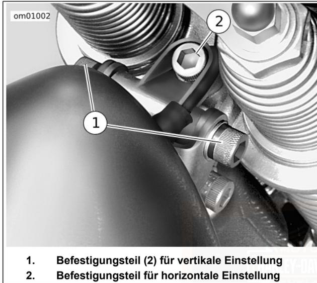
**Abbildung 46. Scheinwerfereinstellung: FLSTSC**
