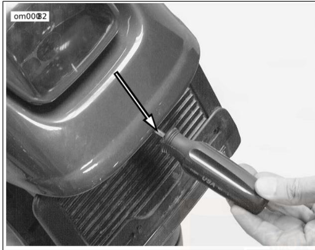
**Abbildung 52. Zugangslot zum Ausbau der Schlussleuchte: FXSTD-Modelle**
