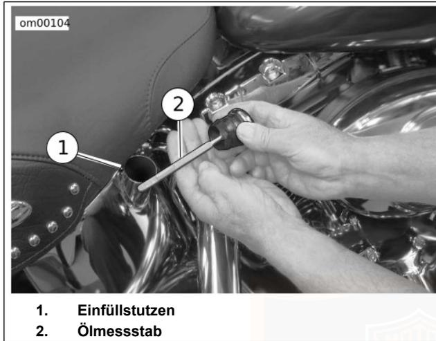
Abbildung 27. Öltankfüllstand prüfen: Softtail-Modelle
