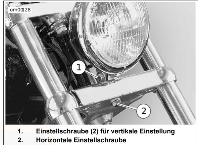
**Abbildung 47. Scheinwerfereinstellung: FLSTC, FLSTF, FXSTB, FXST, FXSTC, FLSTN**
