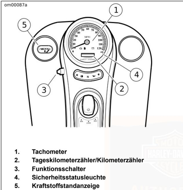
**Abbildung 7. Tachometer/Kilometerzähler: FXSTD-Modelle**
