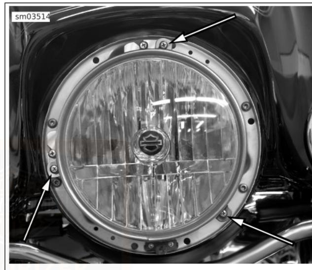
Figure 59. Vis typiques de retenue de phare
