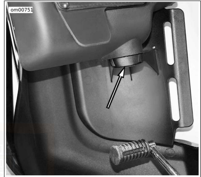
**Figure 25. Contrôle de lames d'aérateur de carénage**
