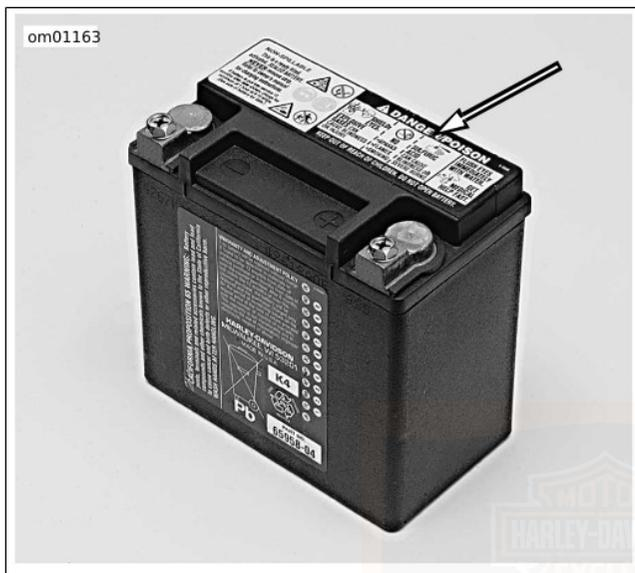
Figure 69. Étiquette d'avertissement sur la batterie
