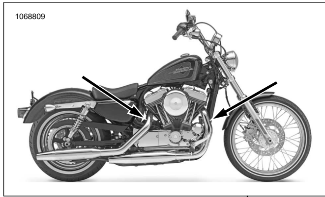
รูปภาพ 48 ตำแหน่งเซ็นเซอร์วัดออกซิเจน (ภายในเครื่องของท่อไอเสีย)
