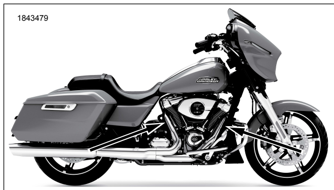
รูปภาพ 2 ตำแหน่งเซ็นเซอร์วัดออกซิเจน (ภายในเครื่องของท่อไอเสีย)
