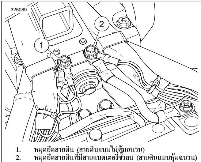
รูปภาพ 34 ตำแหน่งหมุดยึดสายดินกล่องแบตเตอรี่
