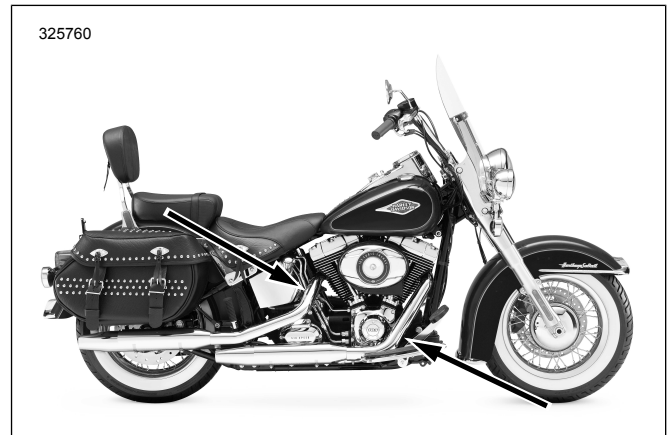
รูปภาพ 33 ตำแหน่งเซ็นเซอร์วัดออกซิเจน (ภายในเครื่องของท่อไอเสีย)
