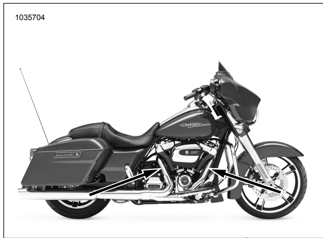
รูปภาพ 11 ตำแหน่งเซ็นเซอร์วัดออกซิเจน (ภายในเครื่องของท่อไอเสีย)
