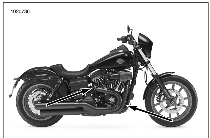
รูปภาพ 40 ตำแหน่งเซ็นเซอร์วัดออกซิเจน (ภายในเครื่องของท่อไอเสีย)
