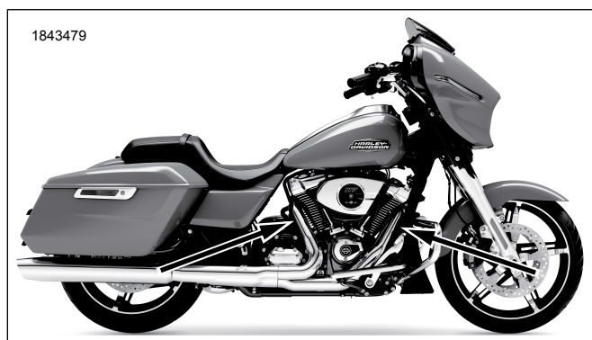
Obrázok 2. Umiestnenia snímačov kyslíka (vnútorná strana výfukových potrubí)
