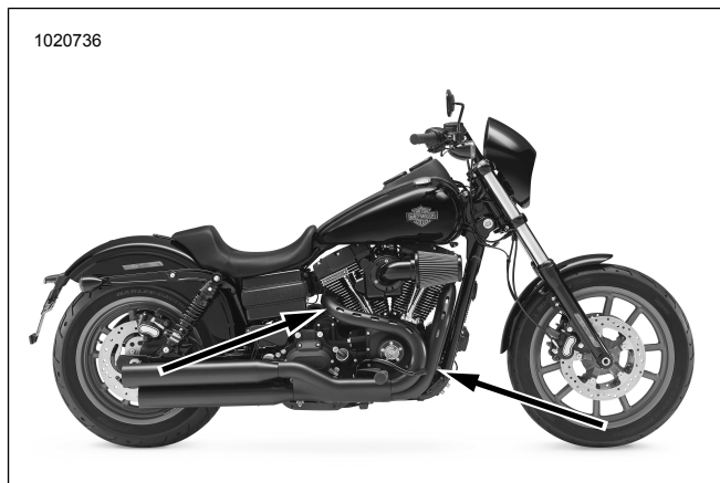
Obrázok 40. Umiestnenia snímačov kyslíka (vnútorná strana výfukových potrubí)
