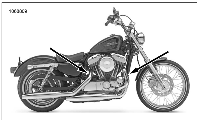
Figure 48. Mga Lokasyon ng Oxygen Sensor (Inboard na Bahagi ng mga Exhaust Pipe)
