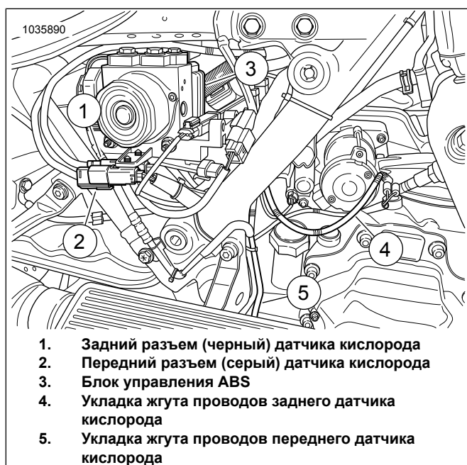
Рисунок 16. Укладка жгута проводов датчика АТМ
