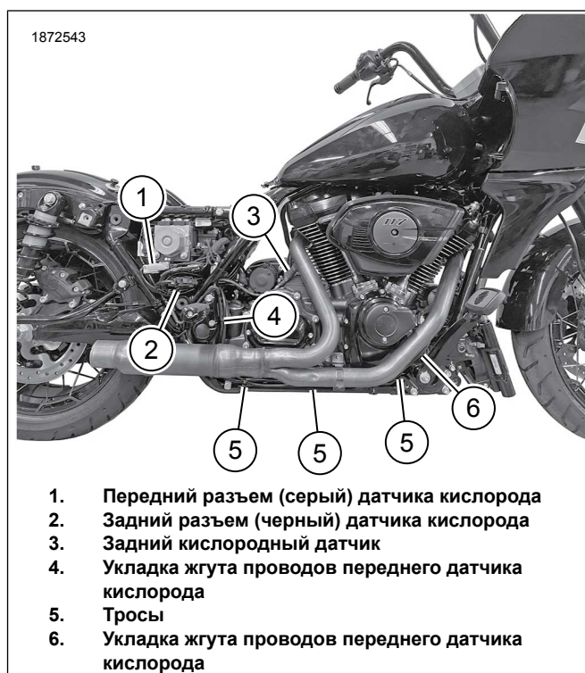
Рисунок 8. Укладка жгута проводов датчика АТМ
