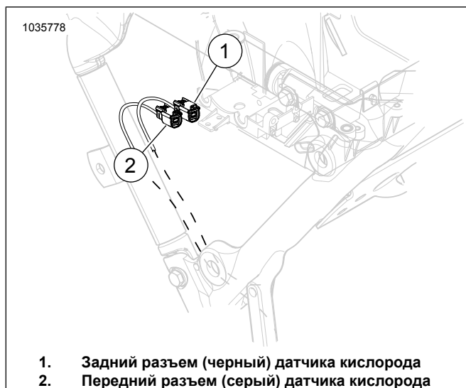
Рисунок 10. Расположение переднего и заднего разъема датчика кислорода
