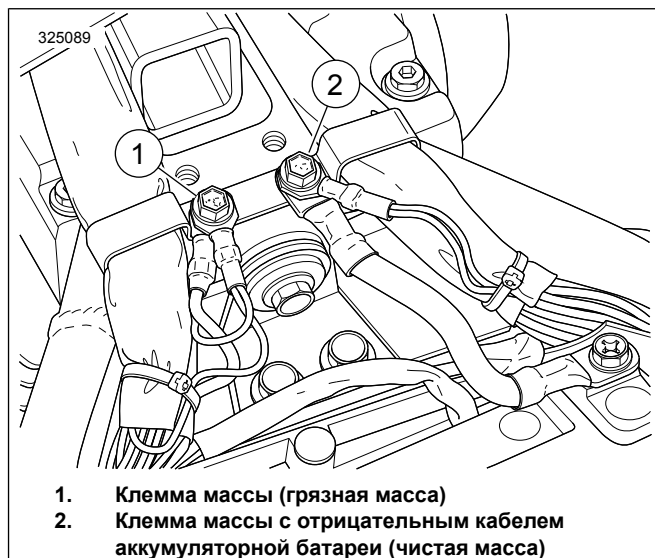
Рисунок 34. Расположения точек соединения с «массой» аккумуляторной батареи
