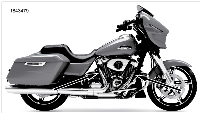
Afbeelding 2. Locaties van de lambdasensor (binnenzijde van uitlaatpijpen)
