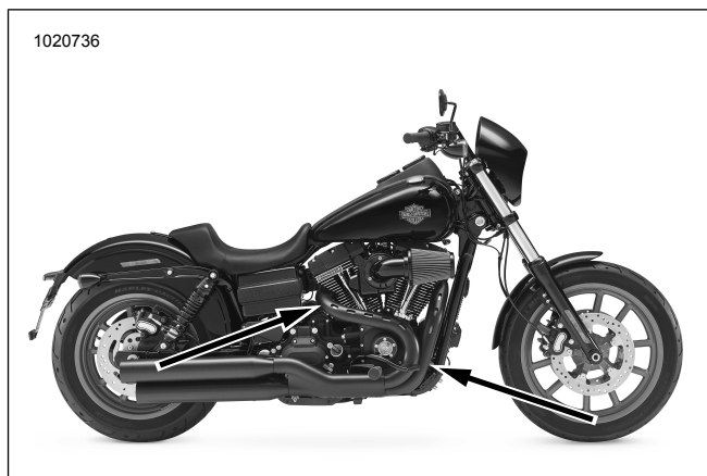
Afbeelding 40. Locaties van de lambdasensor (binnenzijde van uitlaatpijpen)
