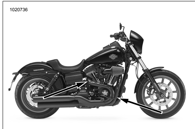
Kuva 40. Happitunnistimien sijainnit (pakoputkien sisäpuolelta)
