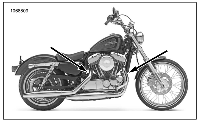
Kuva 48. Happitunnistimien sijainnit (pakoputkien sisäpuoli)
