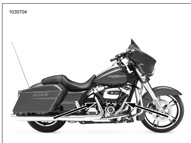
Ilustrace 11. Umístění snímačů kyslíku (vnitřní strana výfukového potrubí)
