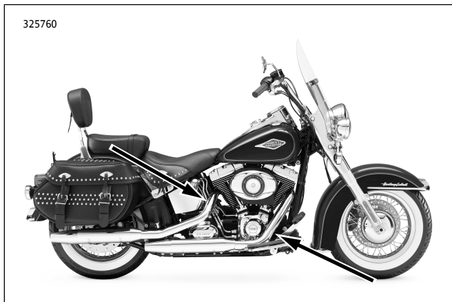
图33. 氧气传感器位置(排气管内侧)
