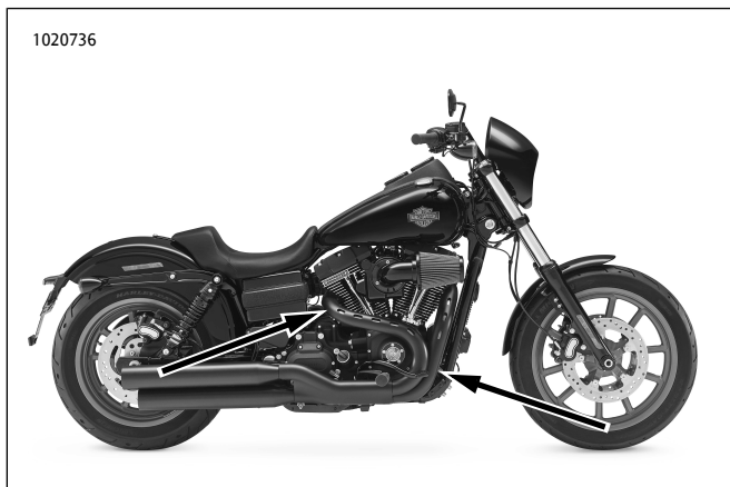
图40. 氧气传感器位置（排气管内侧）
