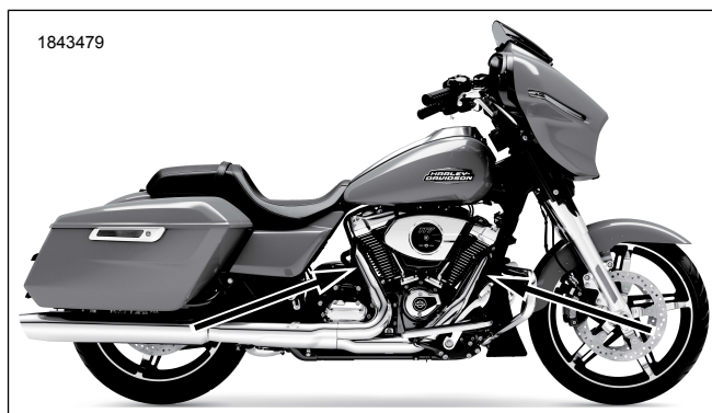
Figur 2. Plassering av oksygensensor (innenbords side av eksosrørene)
