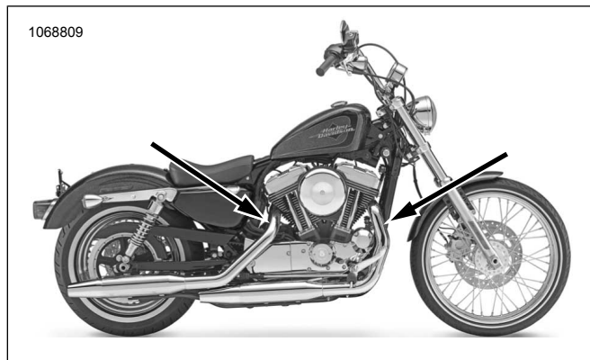
Figur 48. Plassering av oksygen sensor (innenbords side av eksosrørene)
