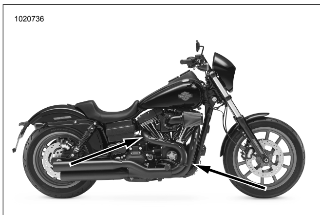
Figur 40. Plassering av oksygensensor (innenbords side av eksosrørene)
