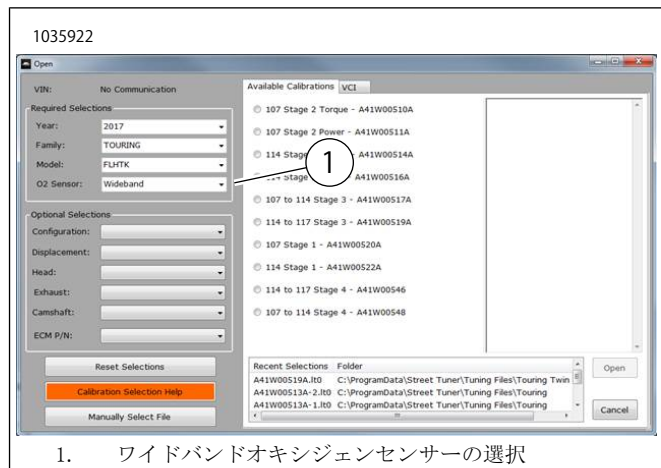
図45。ワイドバンドオキシジェンセンサーの選択
