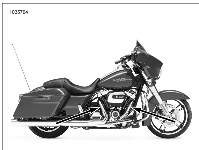
Figura 11. Ubicaciones del sensor de oxígeno (lado interior de los tubos de escape)
