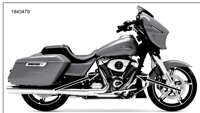
Figura 2. Ubicaciones del sensor de oxígeno (lado interior de los tubos de escape)
