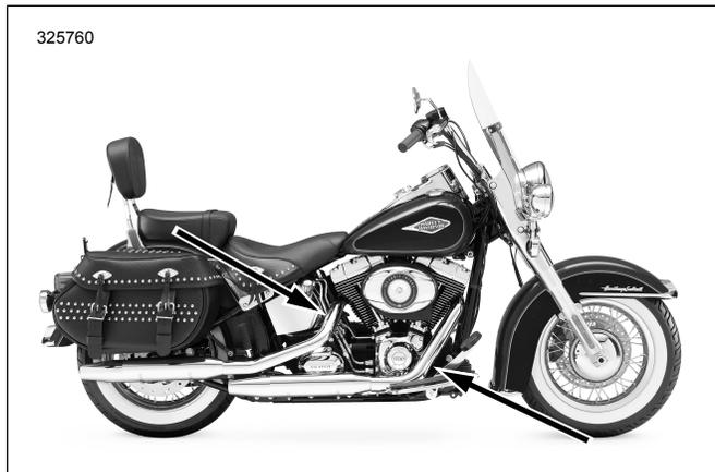
**Abbildung 33. Position der Lambdasonde (Innenseite des Auspuffrohrs)**
