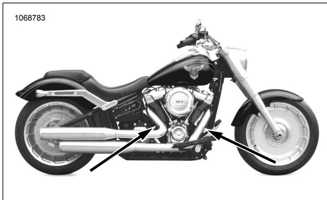
Abbildung 22. Position der Lambdasonde (Innenseite des Auspuffrohrs)
