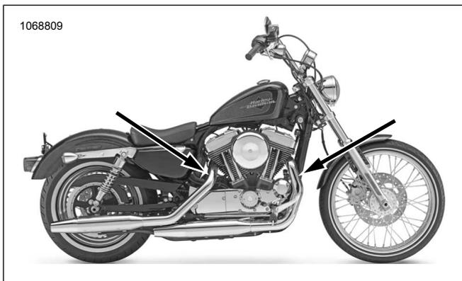
**Abbildung 48. Position der Lambdasonde (Innenseite des Auspuffrohrs)**
