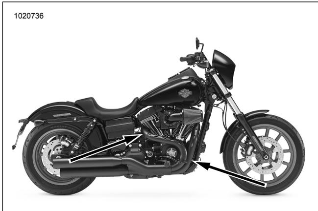
Abbildung 40. Position der Lambdasonde (Innenseite des Auspuffrohrs)
