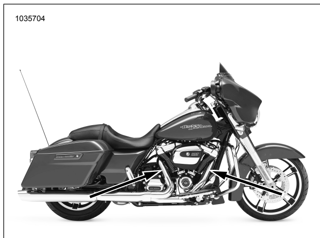
Figur 11. Placeringerne af iltfølere (indvendig side af udstødningsrør)
