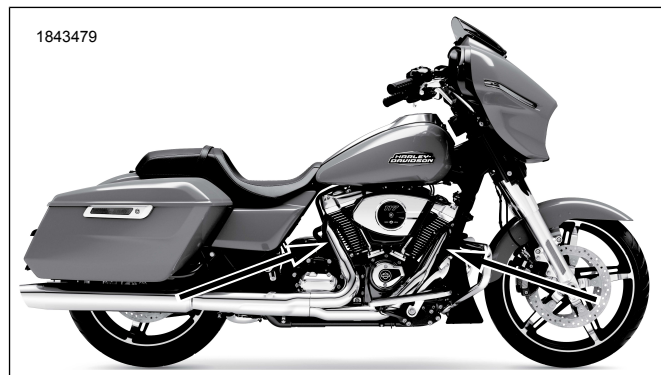
Hình 2. Các vị trí lắp cảm biến oxy (bên trong các ống xả)
