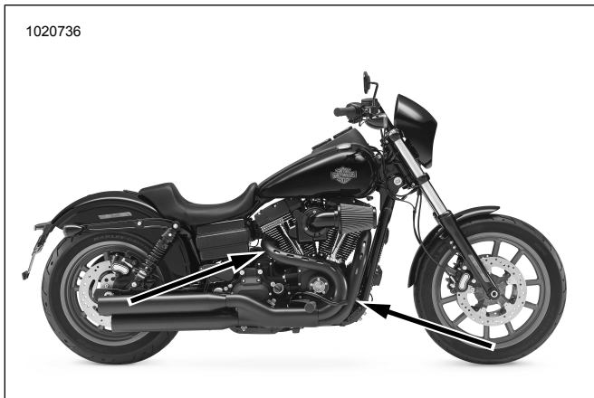
Hình 40. Các vị trí lắp cảm biến oxy (bên trong các ống xả)
