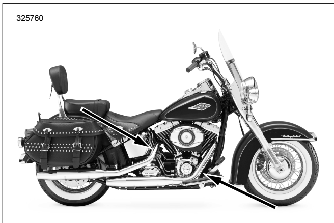
Figura 33. Localizações do sensor de oxigênio (lado interior dos tubos de escape)
