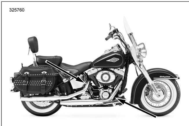
Figure 33. Emplacements de capteur d'oxygène (du côté intérieur des tuyaux d'échappement)
