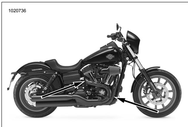
Figure 40. Emplacements de capteur d'oxygène (du côté intérieur des tuyaux d'échappement)
