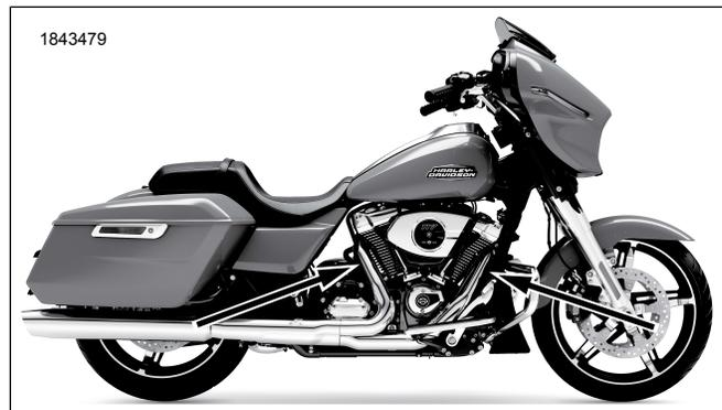
**Figure 2. Emplacements de capteur d'oxygène (du côté intérieur des tuyaux d'échappement)**
