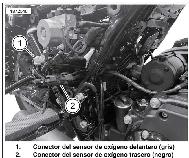
1. Conector del sensor de oxígeno delantero (gris)
