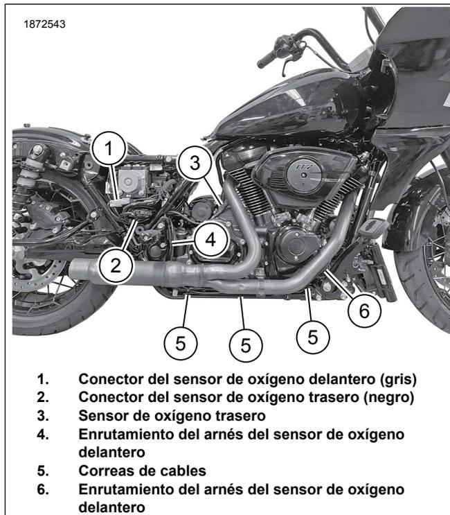
**Figura 8. Ubicación del arnés del sensor del ATM**
