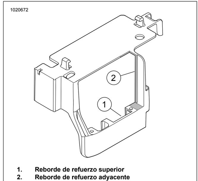
**Figura 30. Recorte de la parte trasera del portabaterías**
