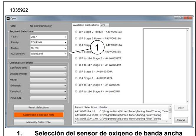
**Figura 9. Selección del sensor de oxígeno de banda ancha**
