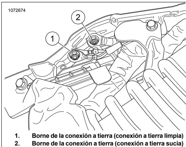
**Figura 23. Conexión a tierra de la estructura**
