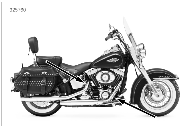
圖33. 氧氣感測器位置（排氣管的內側）
