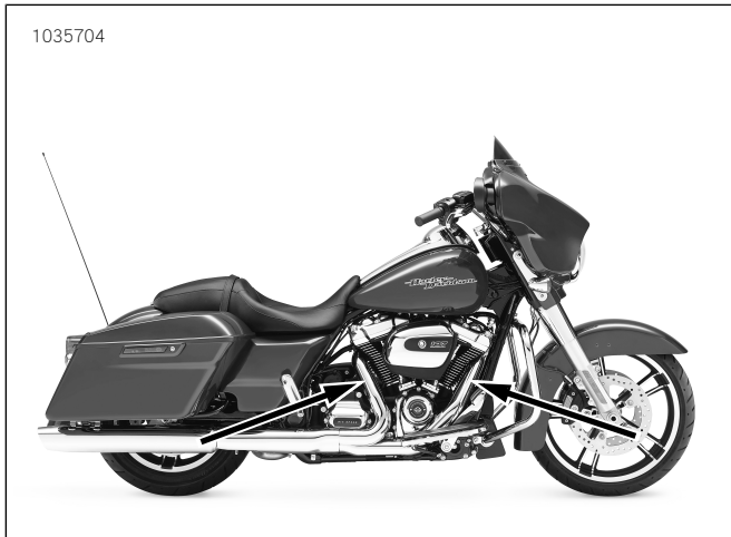
圖11。氧氣感測器位置（排氣管的內側）
