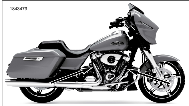
圖2. 氧氣感測器位置( 排氣管的內側 )
