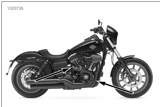
圖40. 氧氣感測器位置(排氣管的內側)
