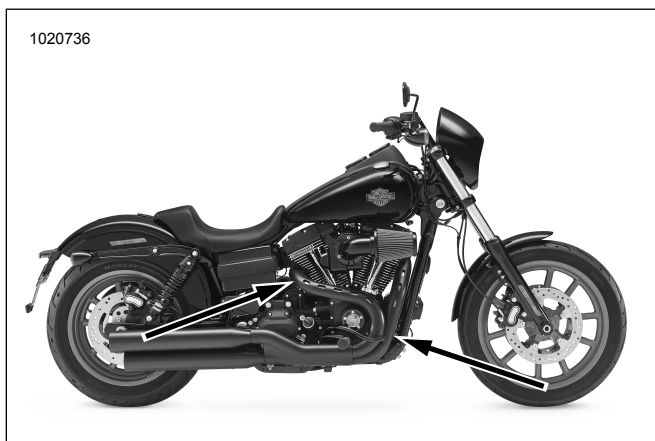
Gambar 40. Lokasi Sensor Oksigen (Sisi Dalam Knalpot)
