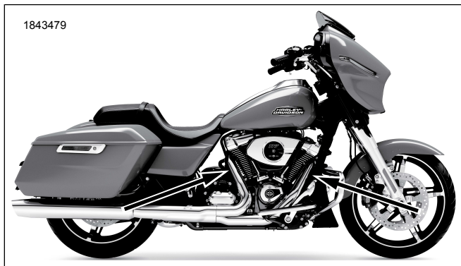
Gambar 2. Lokasi Sensor Oksigen (Sisi Dalam Knalpot)
