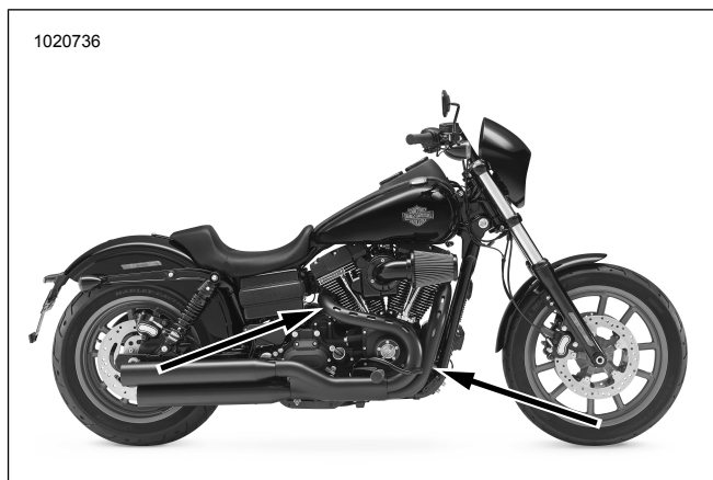
Figura 40. Locațiile senzorului de oxigen (partea interioară a țevilor de eșapament)
