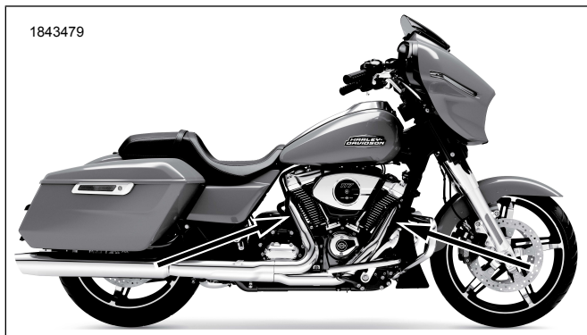
Ábra 2. A lambdaszondák elhelyezkedése (a kipufogócső belső felén)
