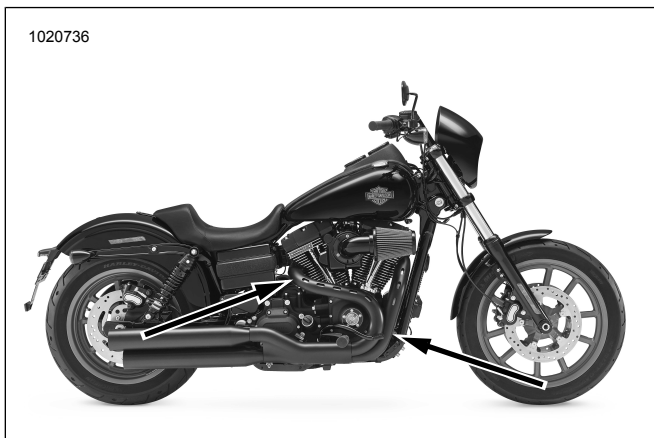
Ábra 40. A lambdaszondák elhelyezkedése (a kipufogócső belső felén)
