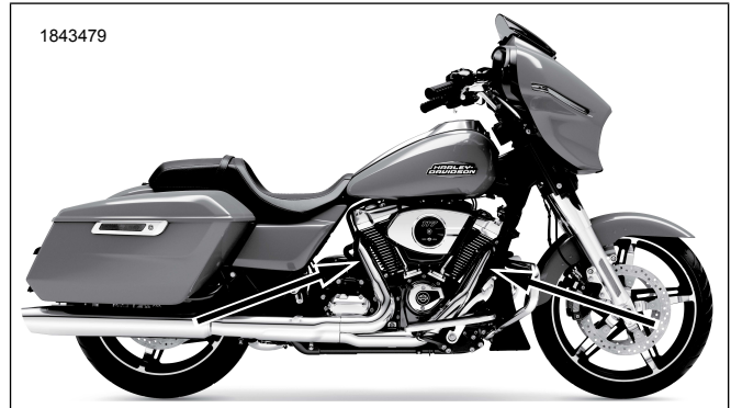
Şekil 2. Oksijen Sensörü Konumları (Egzoz Borularının İç Tarafı)
