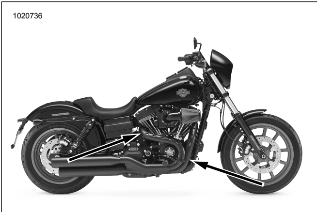
Şekil 40. Oksijen Sensörü Konumları (Egzoz Borularının İç Tarafı)
