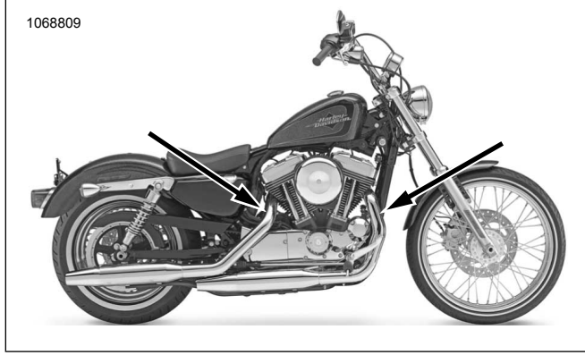
Şekil 48. Oksijen Sensörü Konumları (Egzoz Borularının İç Tarafı)
