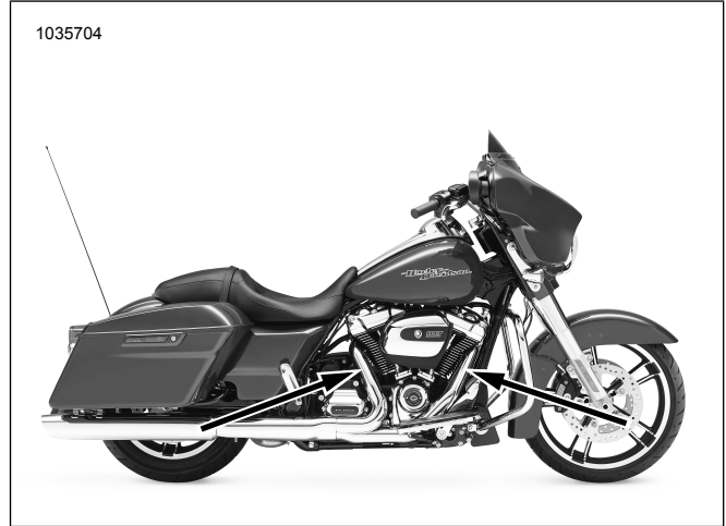
Şekil 11. Oksijen Sensörü Konumları (Egzoz Borularının İç Tarafı)
