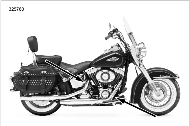
Şekil 33. Oksijen Sensörü Konumları (Egzoz Borularının İç Tarafı)
