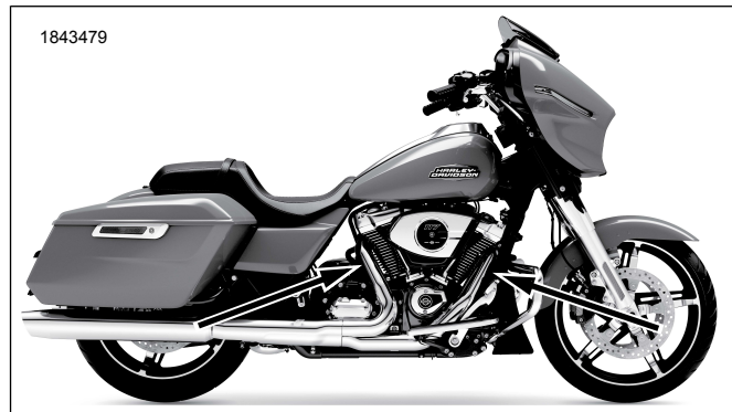
그림 2. 산소 센서 위치(배기 파이프의 안쪽 측면)
