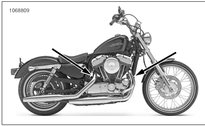
그림 48. 산소 센서 위치(배기 파이프의 안쪽 측면)
