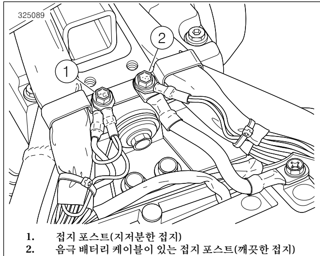
그림 34. 배터리 박스 접지 포스트 위치
