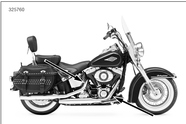
그림 33. 산소 센서 위치(배기 파이프의 안쪽 측면)
