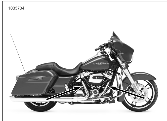
그림 11. 산소 센서 위치(배기 파이프의 안쪽 측면)
