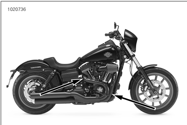
그림 40. 산소 센서 위치(배기 파이프의 안쪽 측면)
